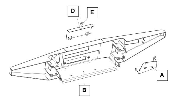
1 x Seilwindenstoßstange (B)
